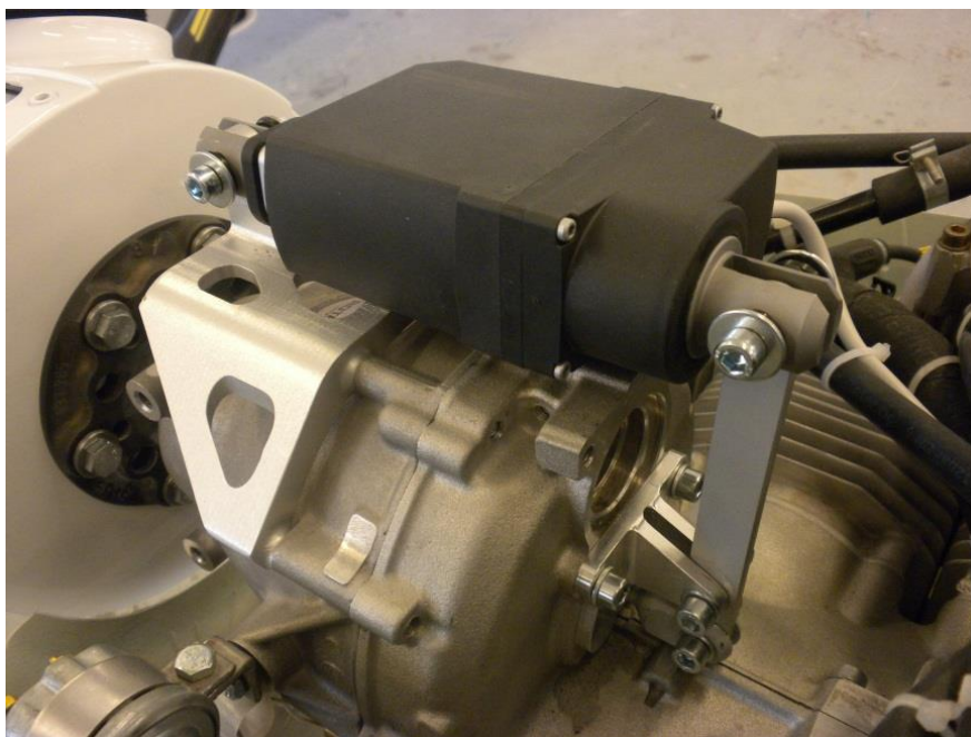
Obr. 11 Montáž zvrtné páky servomotoru s držákem
