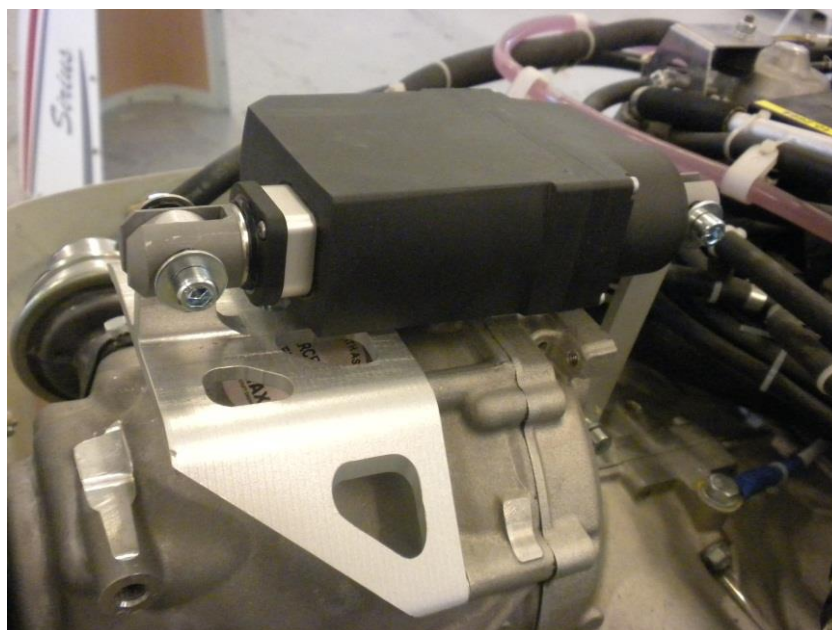
Obr. 9 Montáž servomotoru s držákem
