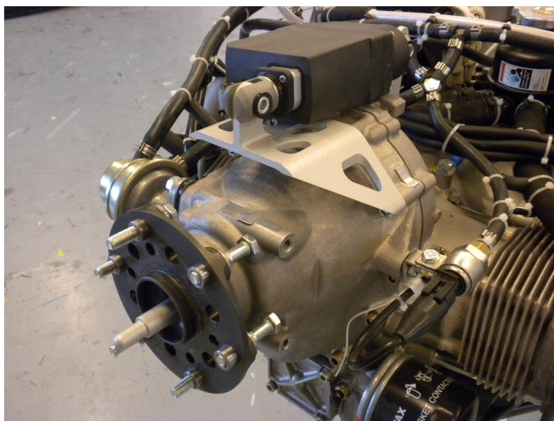
Obr. 13 Instalace osy ovládání vrtule
