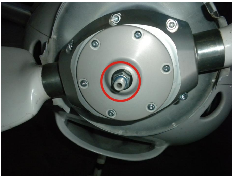
Obr. 21 Utažení matice M 12
