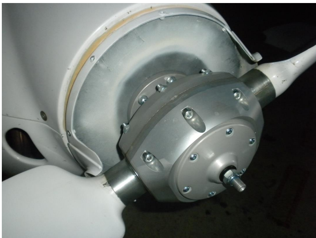
Obr. 17 Montáž vrtule na přírubu reduktoru
