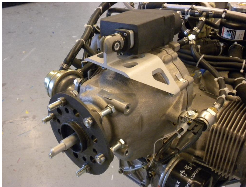
Obr. 13 Instalace osy ovládání vrtule
