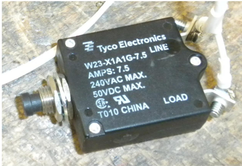
7,5 A pojistka Tyco Electronics W23-X1A1G-7,5
