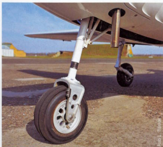
Podvozek je odpružen gumovými bloky v kombinaci s tlumičem
