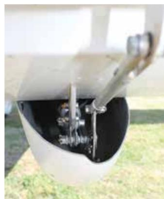
Il comando dell'elevatore e quello del trim sono integralmente ispezionabili nel check prevolo
